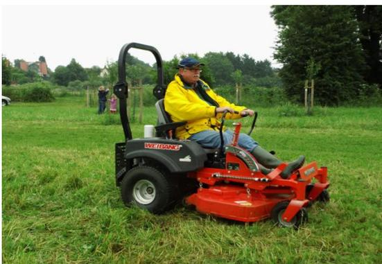
*Die Wiese mähen wir mit einem Mulchmäher, der selbst mit kniehohem Gras fertig wird. Der seniorengerechte Aufsitzmäher ist ein richtiges Kraftpaket: 19 PS Benzin-motor, Drei-Messer-Mulchmähwerk, Höhenverstellung bis 1,2 Meter, Schnittbreite 122 cm. Der Mulcher zerkleinert Gras sehr fein. Das stark zerhackelte Mähgut bleibt auf dem Boden liegen und zersetzt sich weitestgehend bereits nach vier Wochen. Somit werden die Baumwurzeln ausreichend mit Nährstoffen versorgt.*
